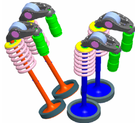
Schlepphebeltrieb als verwendete Basis zum Aufbau der variablen Ventilsteuerung
