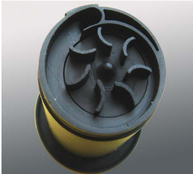
Kunststoffabgüsse der Rapid Prototyping Bauteile
