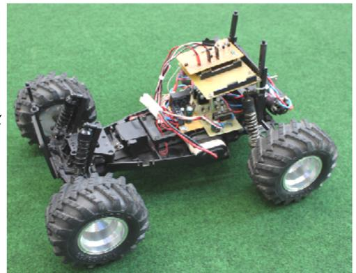
Fernsteuerung eines Modellfahrzeugs über eine Punkt-zu-Punkt-Verbindung über Bluetooth von einem Smartphone aus
