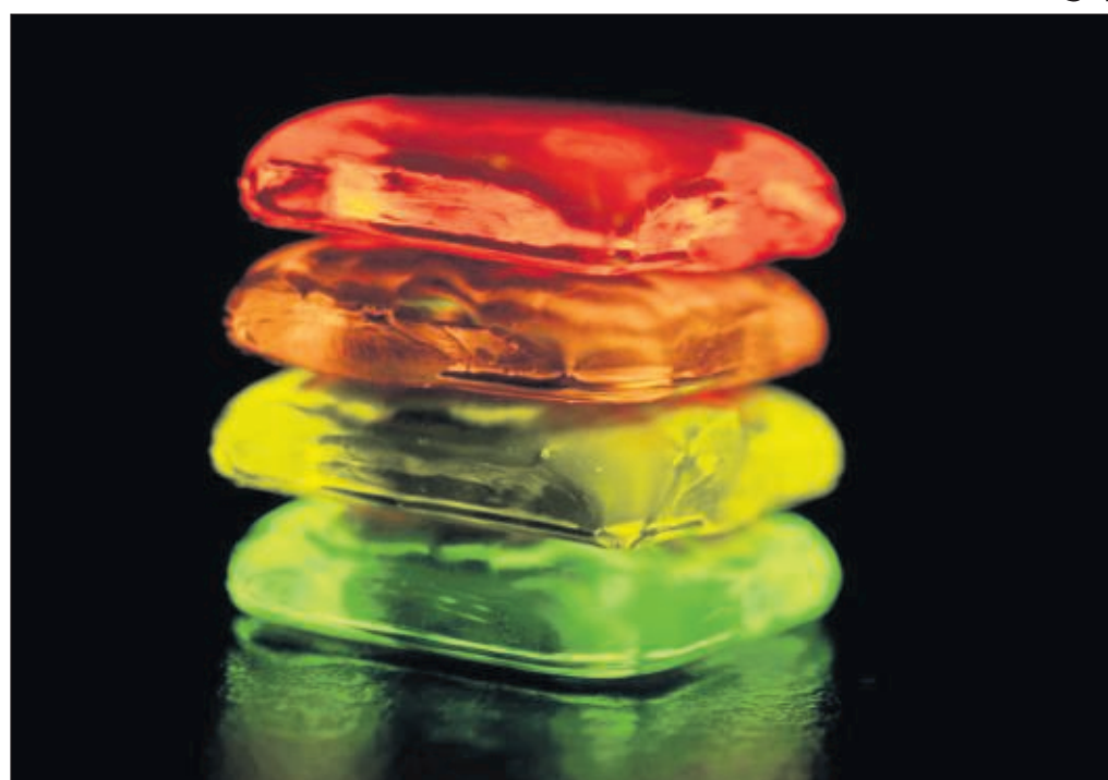
Mit Leuchtstoffen versetzte Gläser unter Einwirkung von ultraviolett/blauem Licht. ■ Foto: Ahrens
