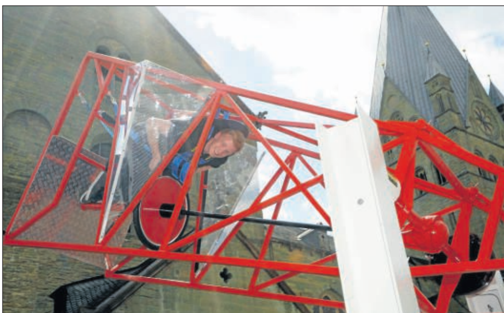
Bis zum Anschlag: Holger Strunk führte den „Loop Hunter“, die Überschlagschaukel der Maschinenbauer, gerne vor. Mit eigener Muskelkraft lässt sich die Schaukel in Schwung bringen.
