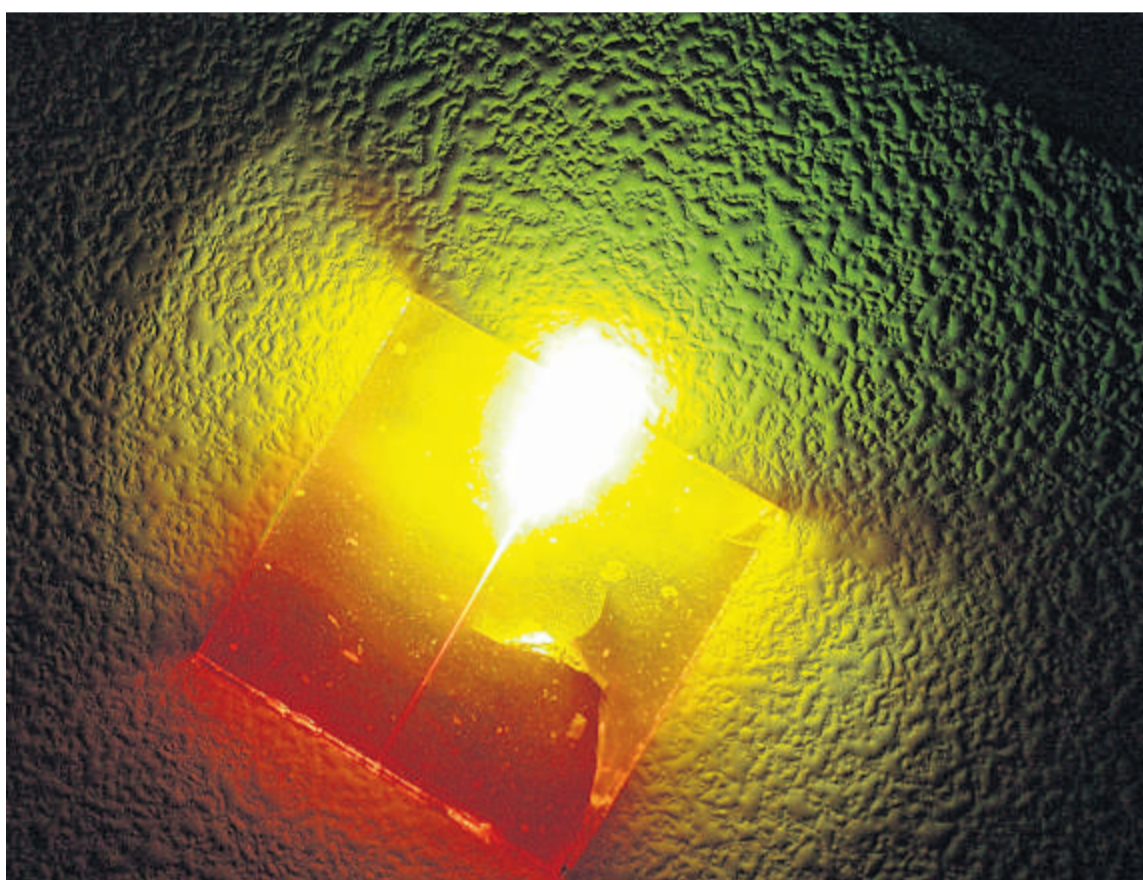
Forschung im Fachbereich Elektrische Energietechnik in Soest: Ein Infrarot-Laserstrahl trifft auf ein mit seltenen-Erden-dotiertes Glas und wird zu sichtbarem Licht umgewandelt. Das Laborteam hat das Bild „Engel“ getauft. FOTO: FH SÜDWESTFALEN
