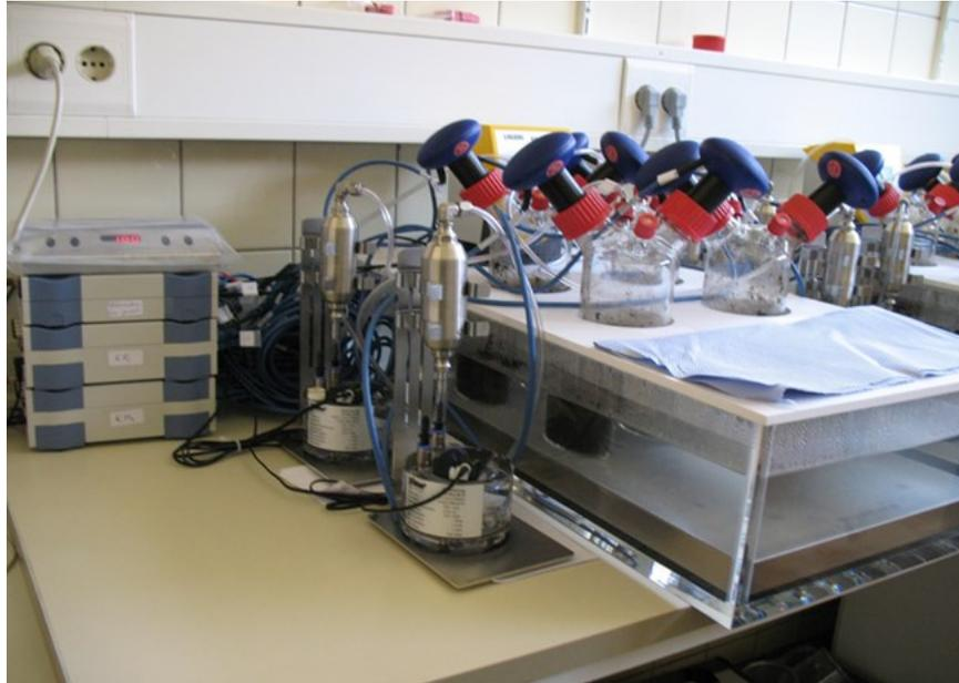
Abbildung 5: Sensorbiogasanlage „Yield-Master“
