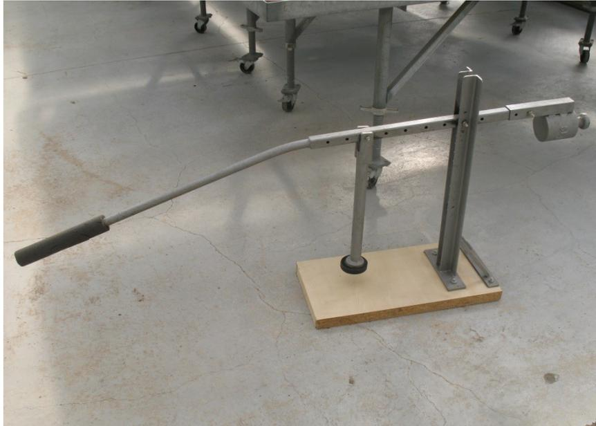
Abbildung 3: Silageverdichter zum Verfestigen von Laborsilagen
