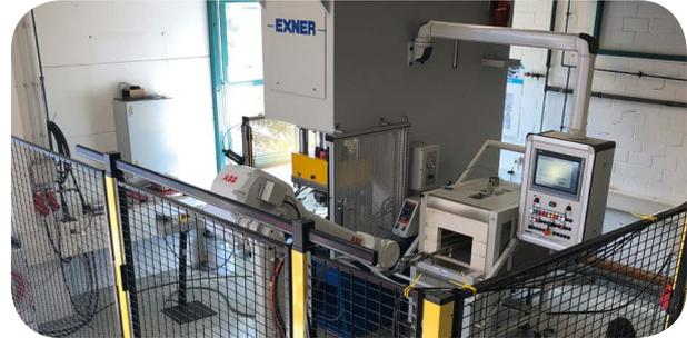
Die neu entwickelte Roboterzelle mit 100t-Servopresse, Glühofen, übergeordneter Anlagensteuerung und Einhausung
