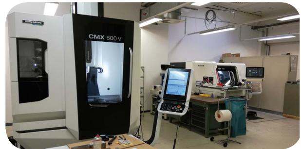
*Das Labor für Fertigungstechnik mit neuer Ausstattung: CNC-Fräsmaschine CMX600V und CNC-Drehmaschine NEF400*
