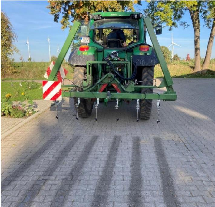
Abbildung 10: Arbeitsbild der Bandspritzung
